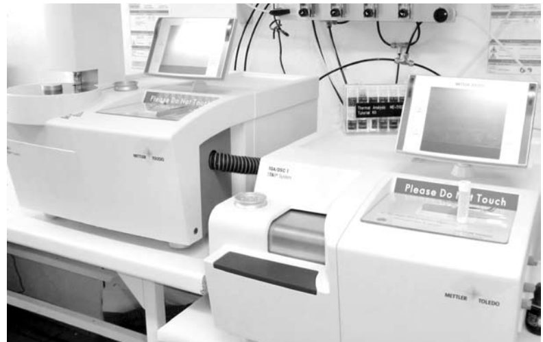
Appareil d'analyse thermique DSC et ATG pour l'étude du comportement thermique des polymères commercialisé par Mettler Toledo
